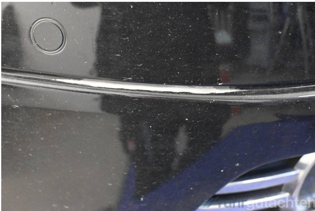
Nicht reparierter Vorschaden: Stoßfänger vorne Lackabplatzung
