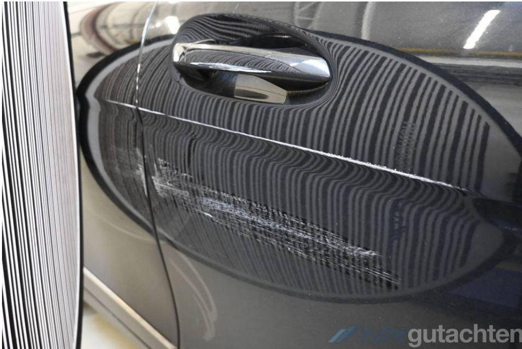
Tür vorne rechts kratzbeschädigt
