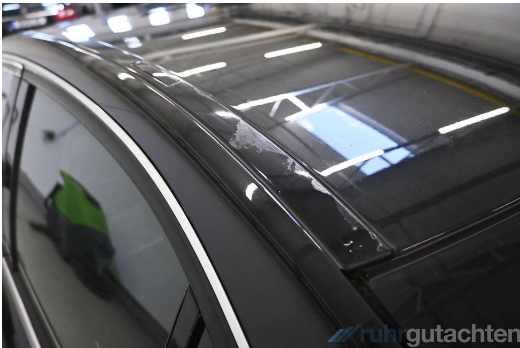
Nicht reparierter Vorschaden: Dachleiste links korrodiert
