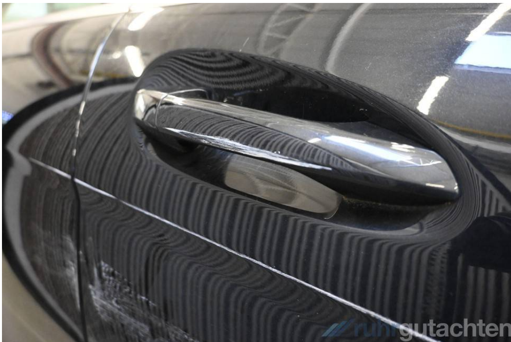
Türgriff vorne rechts kratzbeschädigt
