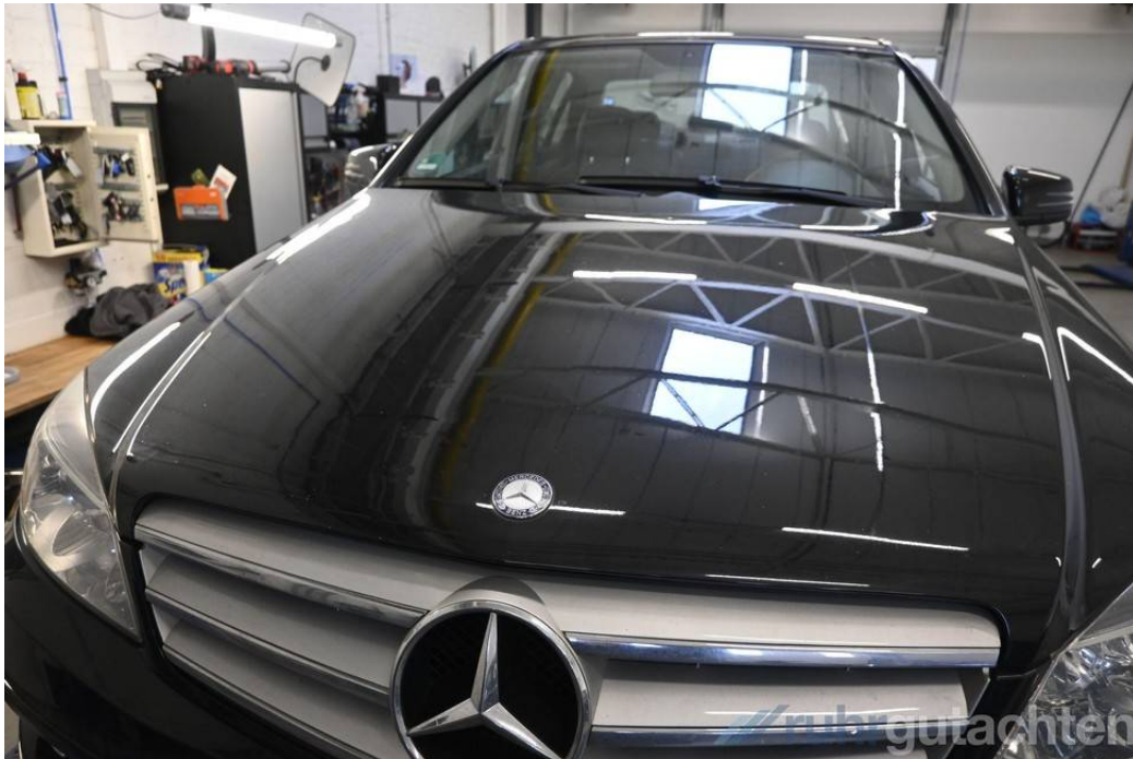
Nicht reparierter Vorschaden: Frontklappe verformt
