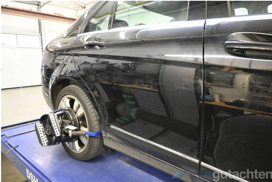
Nicht reparierter Vorschaden: Tür hinten rechts eingedellt
