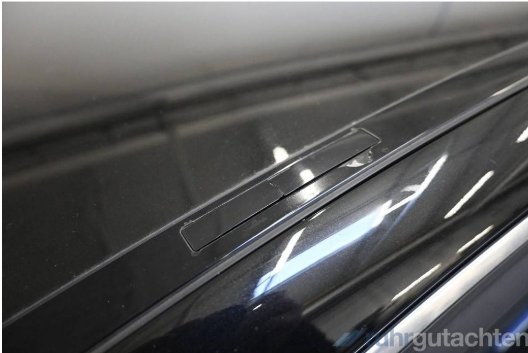
Nicht reparierter Vorschaden: Dachleiste rechts Abdeckung gebrochen
